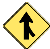
Incorporación de tránsito
